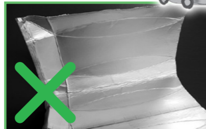
×ラミネート紙、樹脂・アルミ コーティング紙(飲料パック)
