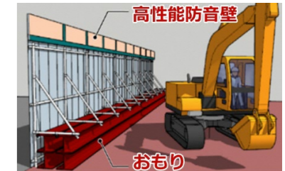
おもり、防音壁設置例
