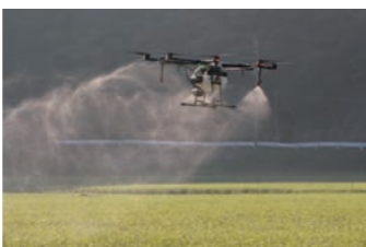
栽培支援ドローンによる農薬散布の様子
