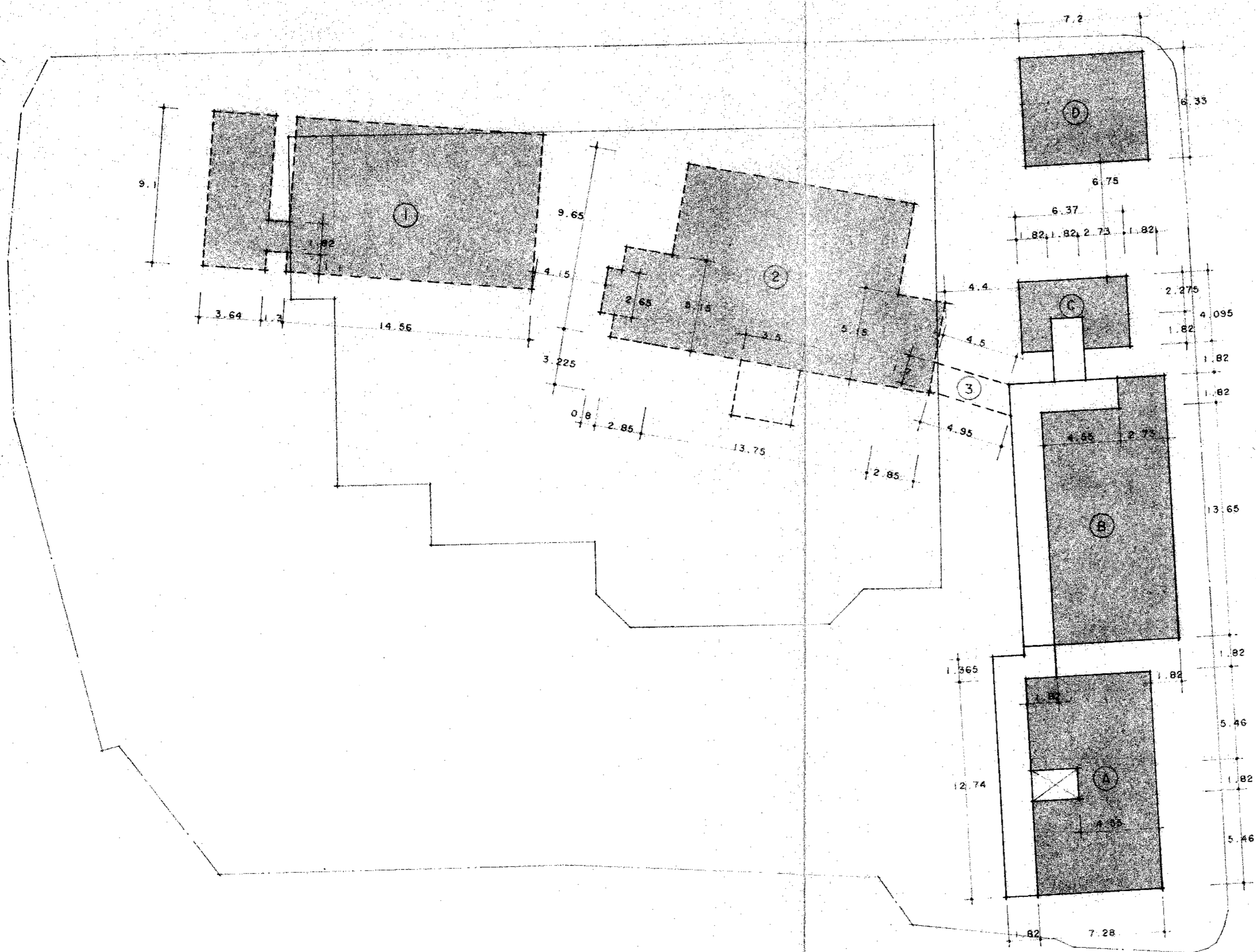
既存建物，解体建物面積計算図 S=1/200
