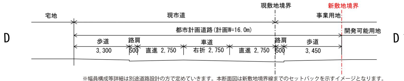
※幅員構成等詳細は別途道路設計の方で定めていきます。本断面図は新敷地境界線までのセットバックを示すイメージとなります。
