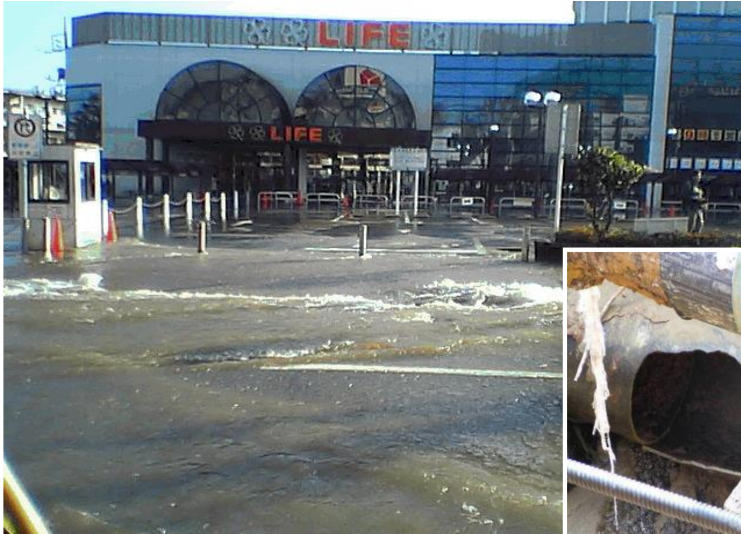
H17.03.03 500mm鑄鉄管(昭和35年布設) 東京都水道局提供
