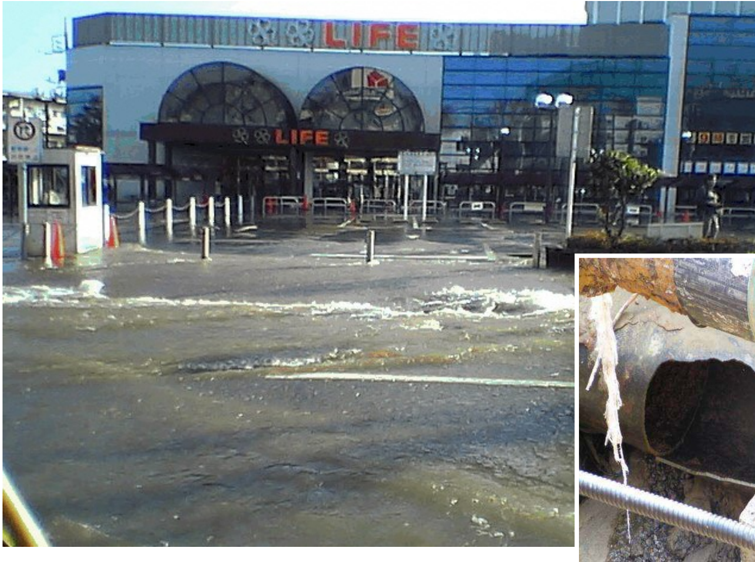
H17.03.03 500mm鑄鉄管(昭和35年布設) 東京都水道局提供
