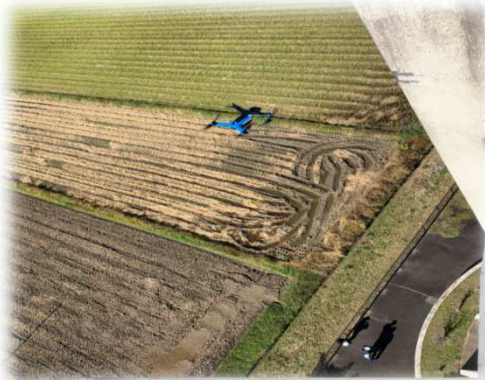
空中ドローンによる 受水塔外壁撮影
