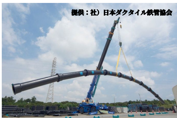
写真7 耐震継手管の性能試験状況（左写真）と耐震継手管による工事（右写真）
