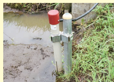
左側の柱が水位センサーで、水温も測ることができます
