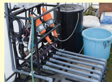
計測されたデータをもとに、設定した水と肥料を供給します
