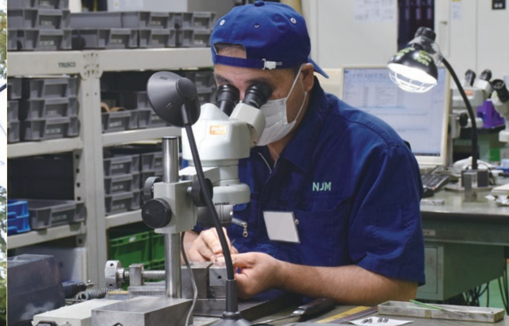
機械で製作された金型は、従業員の手によって仕上げが施されます
