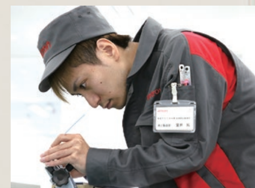
集中しながら電線ハーネスの測定をしています
