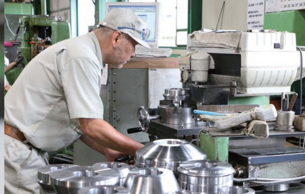
冷間ロール成形機に使われる、さまざまな形状の金型を作っています
