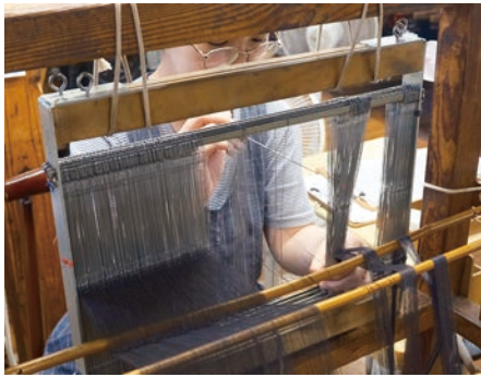
【経通し】 織り機の部品に、経糸を1本ずつ手作業で通していきます
