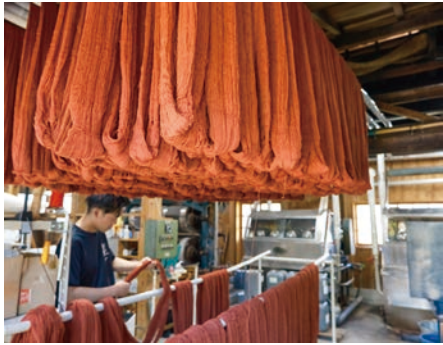
【糸の検品】 糸の太さや状態、ごみが紛れていないかを全て確認します
