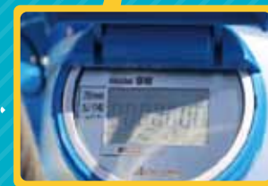
電磁流量計 (スマートメーター)
