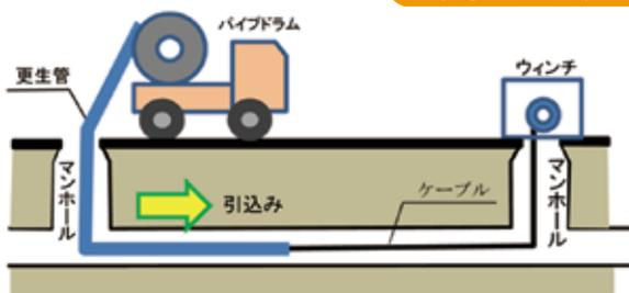
① ウインチからのケーブルを更生管に接続し、マンホールからマンホールへ引込みます。
